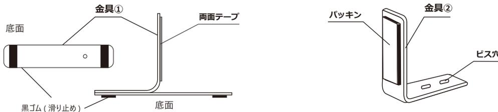
※金具①の両面テープ、金具②のパッキンは取り付けて納品させていただきます。
